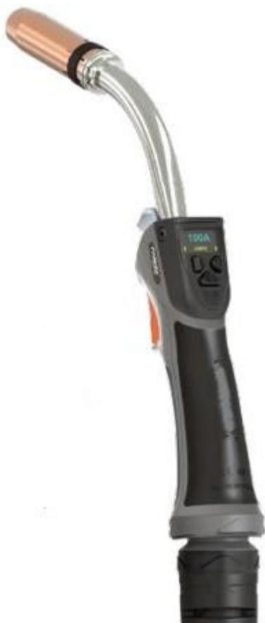
Горелка M-AR-500CC с жидкостным охлаждением, евро-разъемом 4 pin, совместимая со сварочным полуавтоматом ProPuls 500, длина 3,4,5 м, ток 500А
