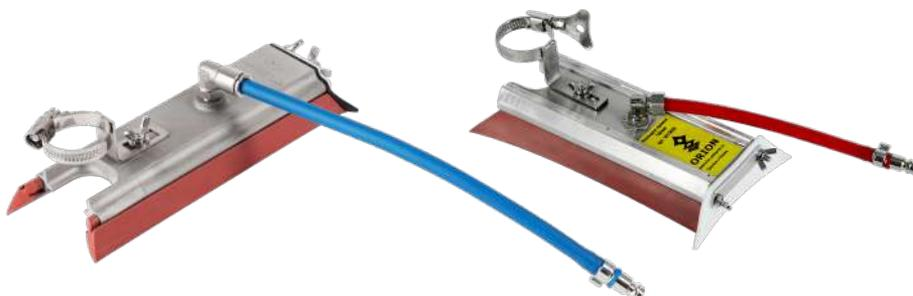
Накладки на горелки используются при сварке титана. Защитный газ подаётся по шлангу и рассеивается через сетку над остывающей сварочной ванной, вытесняя кислород из околошовной зоны.
