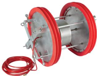
Системы для газовой защиты кольцевых швов применяются в трубах с внутренними диаметрами **от 450 до 1000 мм**, интервал перекрываемых одной системой труб - 10 мм. Расстояние между силиконовыми уплотнениями - 300 мм.
